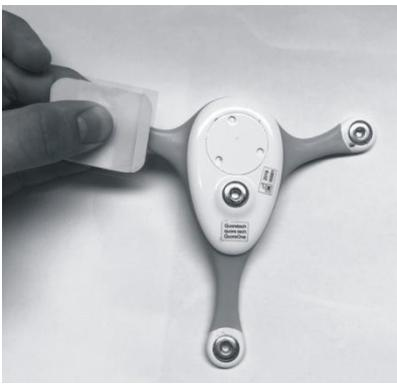
**Figura 13. Encaixe do eletrodo no QuoreOne**
